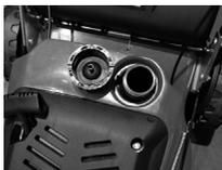
Versare con estrema attenzione il carburante, possibilmente utilizzando un imbuto per evitare di disperdere il carburante all'esterno. La quantità massima è di circa 1 l,0.
